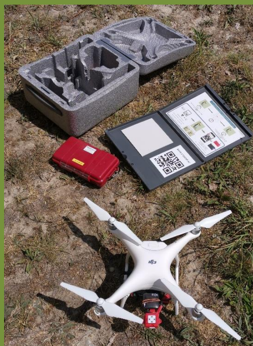
DJI Phantom4 mit Micasense RedEdge.
