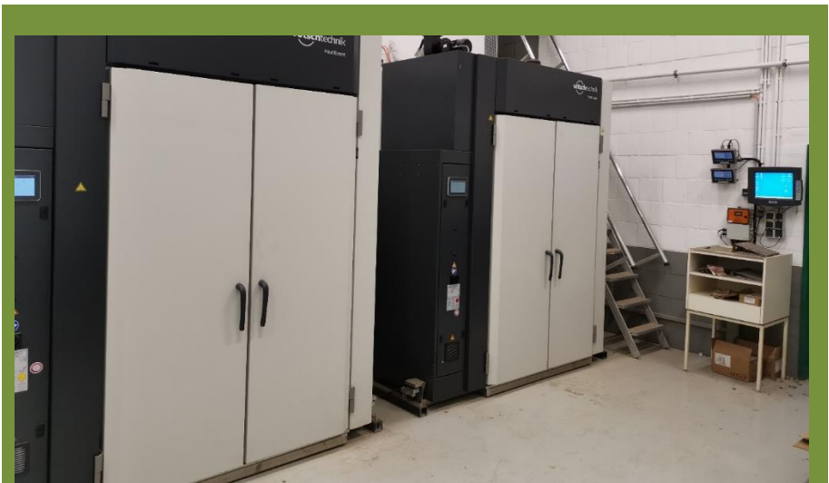
Zwei Trockenschränke Vötsch HeatEvent 125/200 mit Präzisionswiegetechnik.
