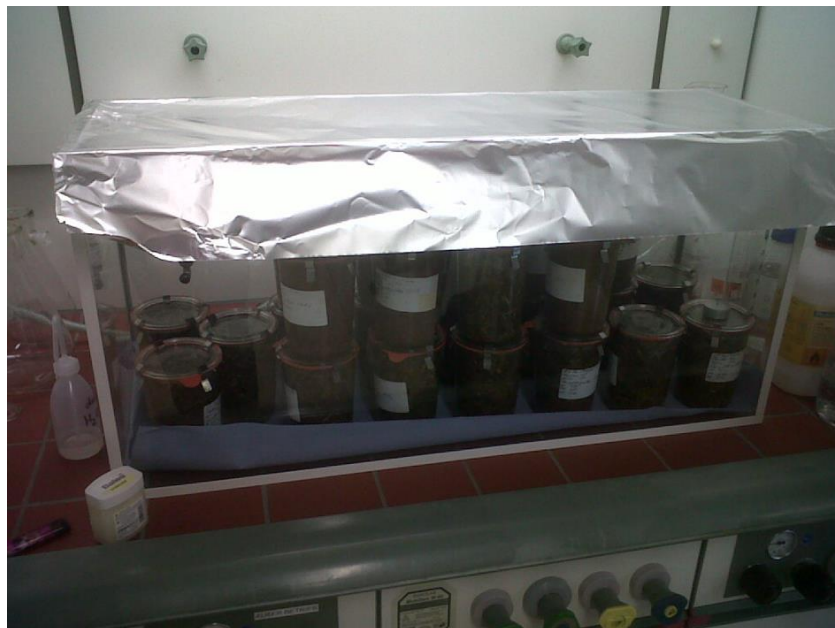
Abb. 3: Silagen in Sturzgläsern (0,75 l), im künstlich erzeugten anaeroben Milieu
