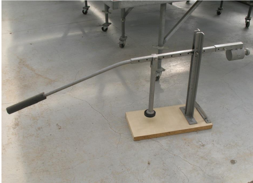
Abb. 2: Silageverdichter zum Verfestigen von Laborsilagen
