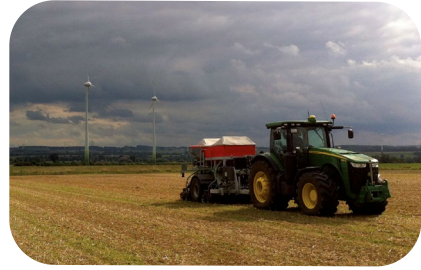
Aufwändige Forschungsfelder zur Ressourcenschonung, Nährstoffeffizienz und Klimarelevanz – Hier der Einsatz einer Cross Slot-Direktsaatmaschine zur Etablierung einer Direktsaat nach Weizen. (Quelle: Hötte)
