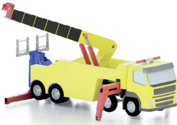
Foto (o.): Leichtbau eines mehrachsigen, drehbaren und verschiebbaren Bergeskrans
