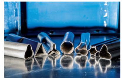
Foto: Inkrementelles Profilumformen ermöglicht praktisch beliebige Geometrien von Rohren, Quelle: TU Dortmund/Roland Baege
